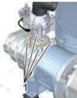
Рис. 35: Крепежные винты регулятора впуска
