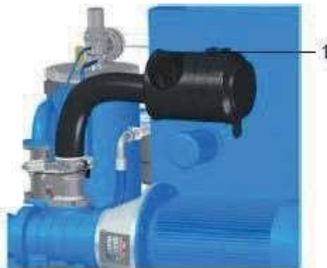
Рис. 41: Расположение воздушного фильтра
