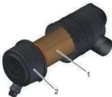
Рис. 42: Разборка корпуса воздушного фильтра
