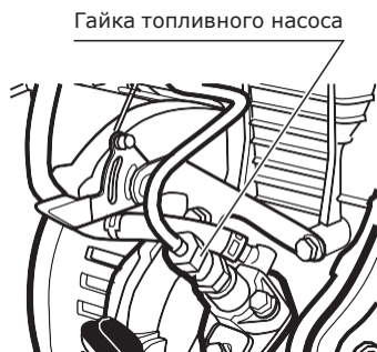
Рис. 16 . Удаление воздуха из топливной системы двигателя
